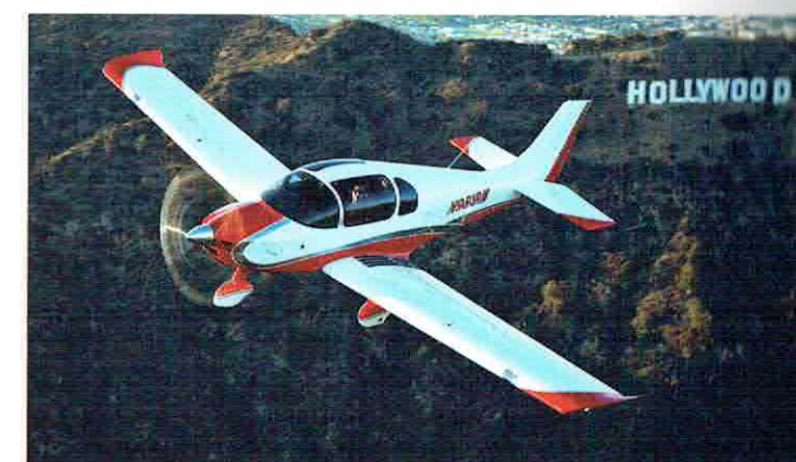
Vierzitter met 115 pk turbocharged Rotax 914 UL-blok. (Foto's: TAF)
