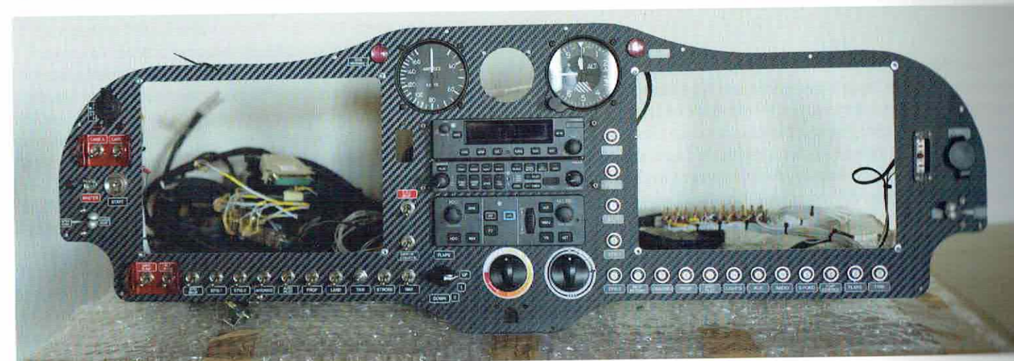
Voorgeboorde panelgaten met bijpassende kabels...
